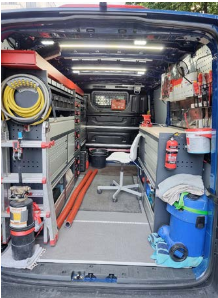
Rollende Werkstatt und mobiles Lager: Innenansicht des Transporters eines Betriebes für Sanitär-, Heizungs- und Klimatechnik Foto: S. Hummrich
